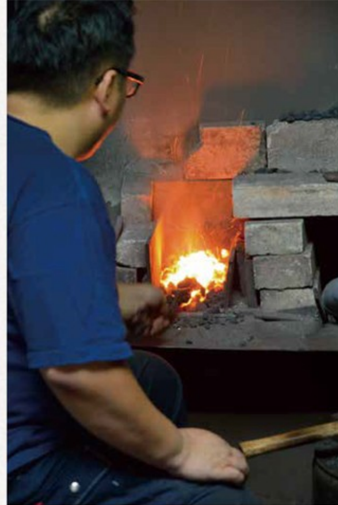
焼き入れ作業を行う祥二郎さん。一つ一つ完全に手作りするため、効率よく作業を進めても1日に包丁2本を作るのがやっと。「型に入れて作る鋳造品と違って、何度もたたいて作った刃は目が細かく、粘りとコシがあって1年くらいは研がなくても切れ味が落ちないですよ」 ※工房は事前連絡をすれば見学も可能。炎の熱気と迫力を体感できる。
