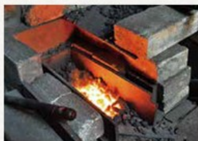
鉄挟みや槌、炉など、刃物づくりに必要な道具は使いやすく自ら手作りのものが多い。代々受け継いできたというのものも
