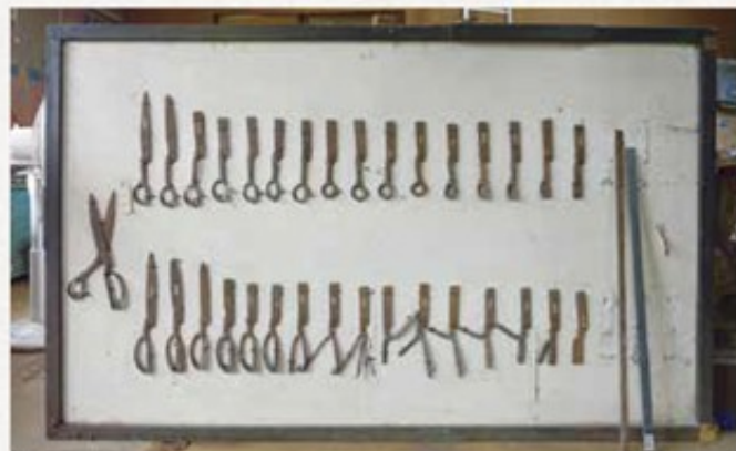
工房に置かれている、鉄製作の工程。六代目はこれを見ながら、自力で作り方を覚えていった。実物を見るのが、何よりの教科書
