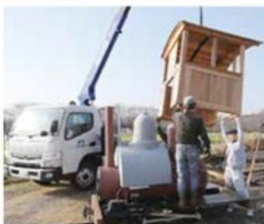
(上)機関車で車両を組み立てる角田さん(左)。プライベートの時間はほぼ車両づくりに費やした。(下)運転室の取り付け作業。完成は間もなくだ。(撮影/羅須地人鉄道協会 高橋卓郎氏)
