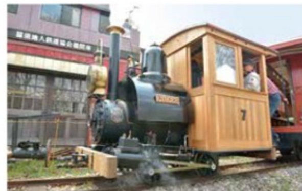
全長に対して大きい運転室や、狭いところにちょこんと取まったサドルタンク、小さい鐘、ひょろりと伸びた煙突など、かわいらしさにあふれた7号機。
