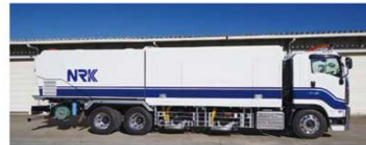
2号機は1号機と同様、全長11m、全幅2.5m、全高3.6mの大型車両です。
