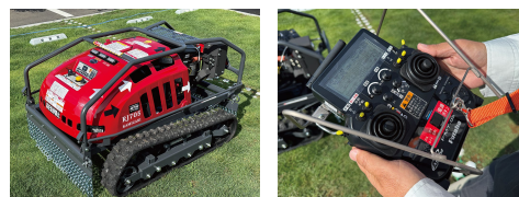
使用最大傾斜角度は前後25度・左右45度。175m離れた地点からでも安全に遠隔操作できます。
